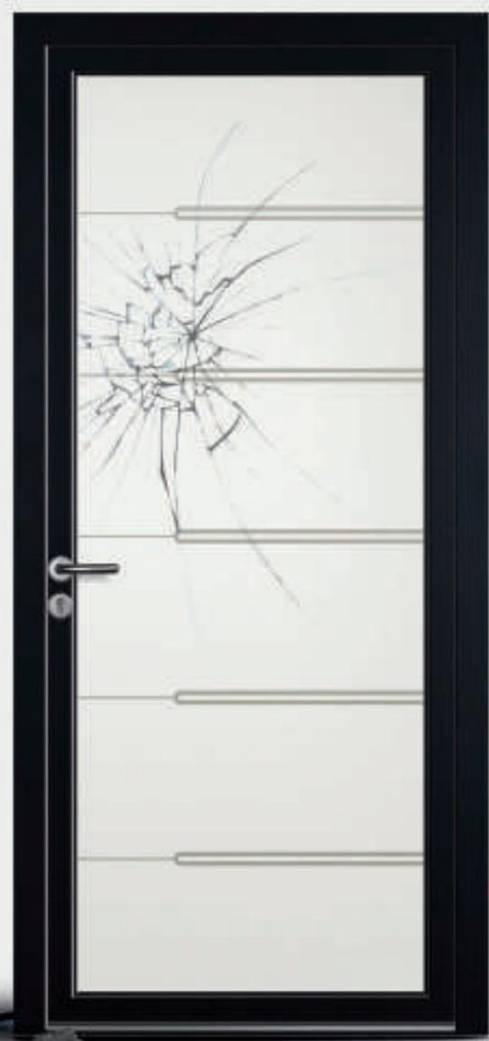
Pour augmenter la protection des habitants et faire face au vandalisme, son verre SP10 est capable de résister à la chute de 9 billes d'acier de 4,11 kg chacune, d'une hauteur de 9 mètres.
