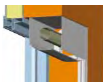
Sous le linteau, enroulement intérieur
