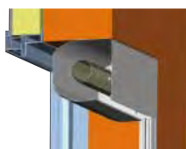
Sous le linteau, enroulement intérieur
